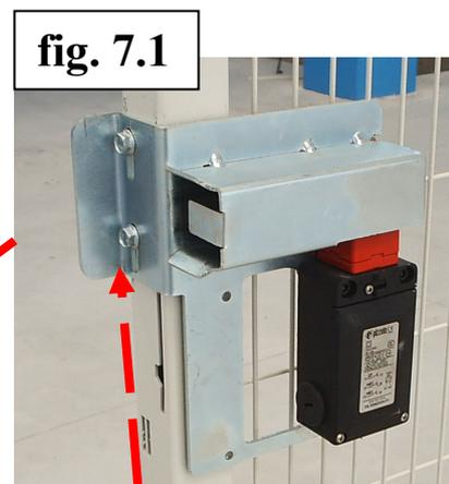
Ultimato il montaggio della protezione, regolare l'allineamento della serratura tramite le 2 viti nelle asole
