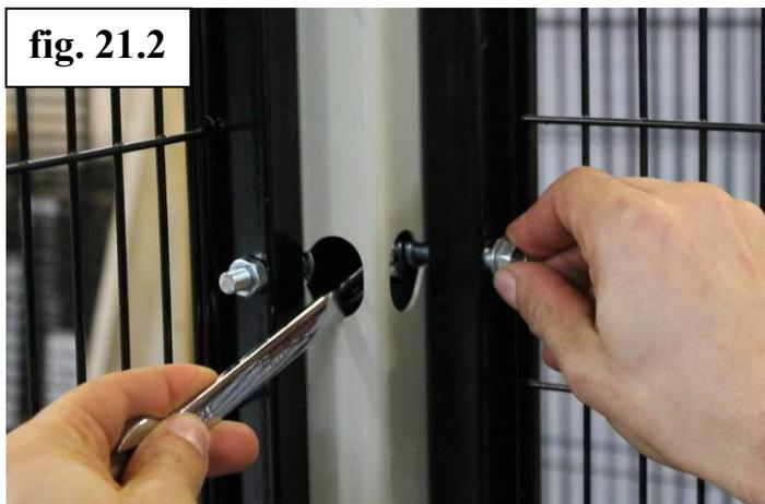
3) Rimontare il telaio e sostituire le viti testa tonda con normali viti m 8x40.
